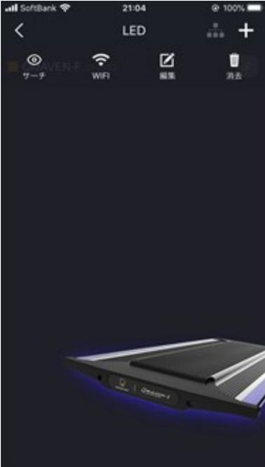
サーチ - 複数台使用時における識別用の機能で、タップすると該当の機器が点滅します。
