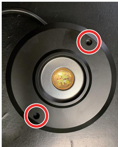
A360x の主なメンテナンスはホコリの除去になります。左の写真にあるネジ 2 力所を外しカバーを開けてください。（トルクスレンチ T10 規格の工具が必要です）カメラ用ブロアー等で吹き飛ばしてください。ボンベタイプのエアダスターは低温で基盤などを破損させる可能性がありますので使用しないでください。
